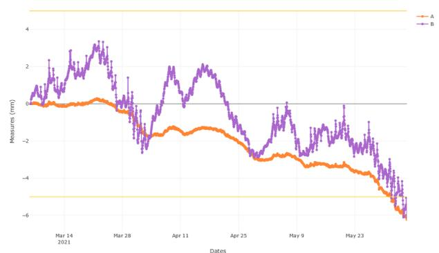
*Desplazamiento horizontal de la columna calculado a partir del clinómetro superior 3103.*
